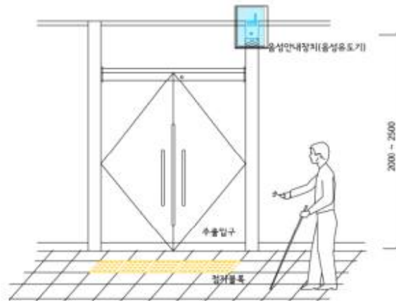
(그림 2-15) 음성안내장치 설치위치 예시
