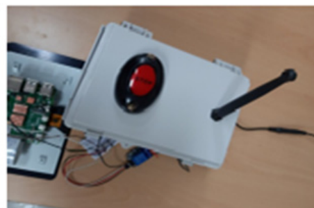
그림 10. 무선 하차 벨 모듈 Fig. 10. Wireless buzzer module
