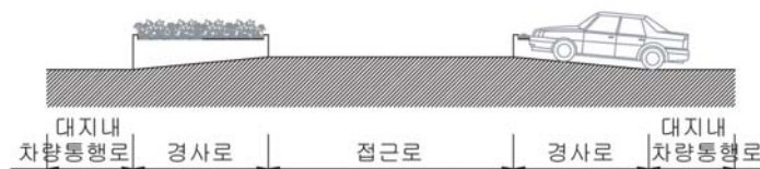
〈그림 3-6〉 교행부분 고원식 횡단보도 설치 단면도
