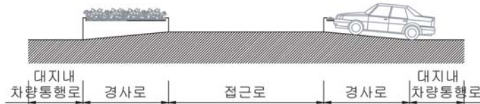
〈그림 4-6〉 교행부분 고원식 횡단보도 설치 단면도
