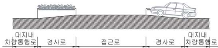
〈그림 2-6〉 교행부분 고원식 횡단보도 설치 단면도
